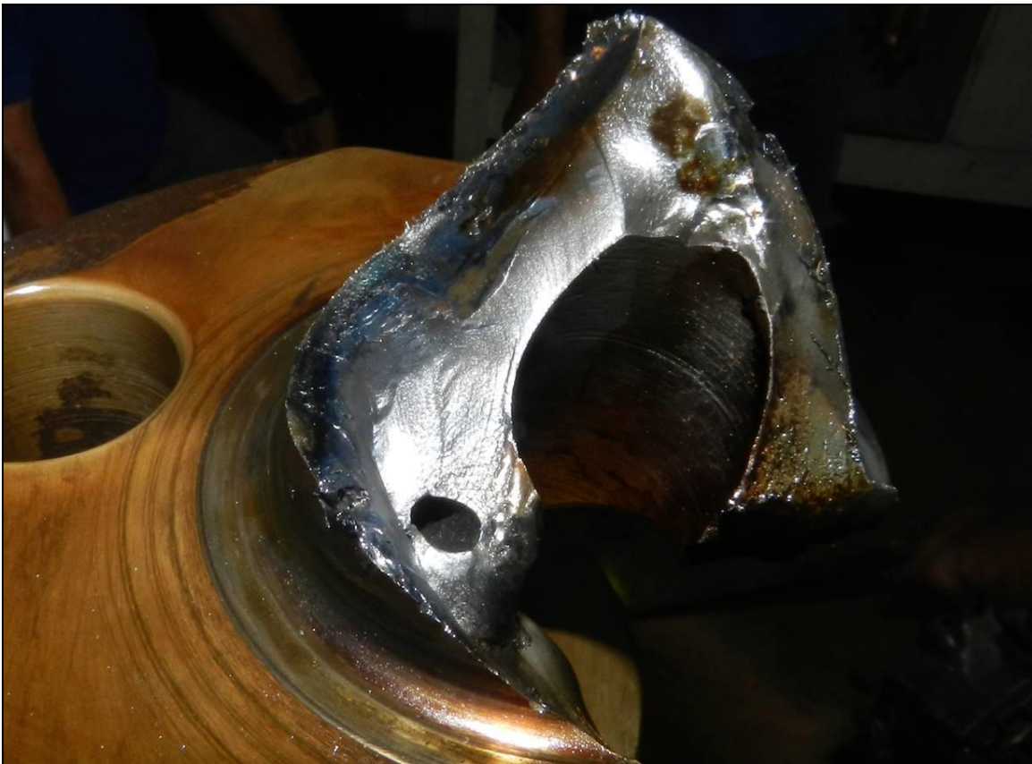
Zona de fractura del cigüeñal del motor Lycoming IO-540 K1G5
