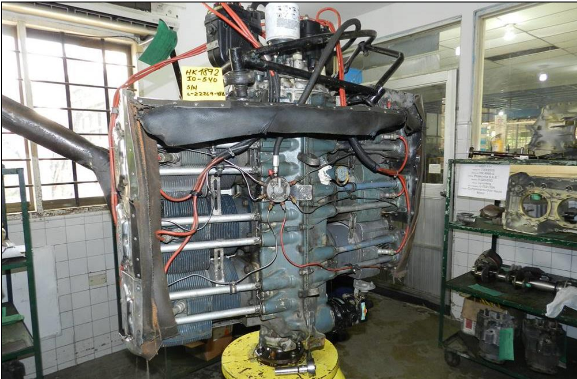
Inspección del Motor Lycoming IO-540 K1G5 S/N L-22269-48A
