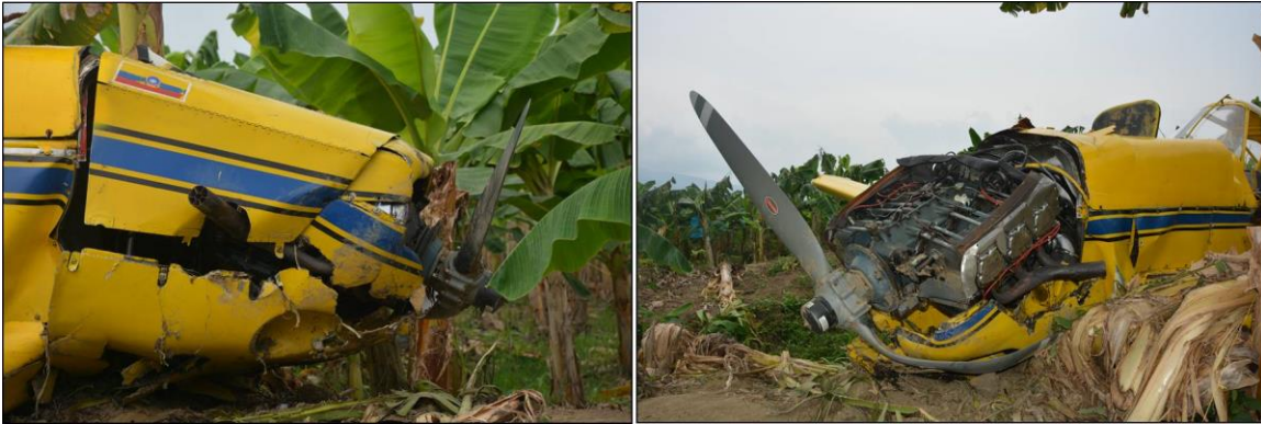
Daños en las cubiertas del motor (Izq.) y pala de la hélice (Der.)
