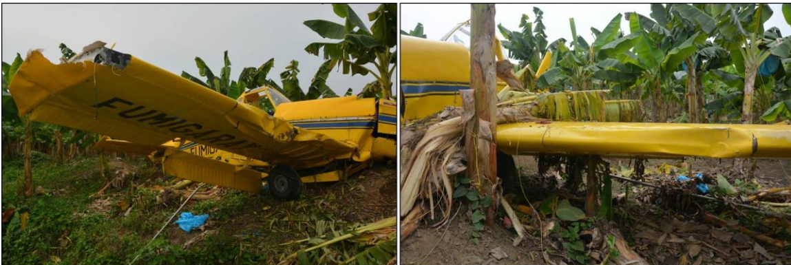
Daños en la punta y borde de ataque del ala derecha (Izq.) y borde de ataque del ala izquierda (Der.)
