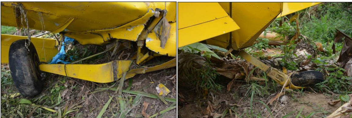
Daños en el tren de aterrizaje principal (Izq.) y de cola (Der.)
